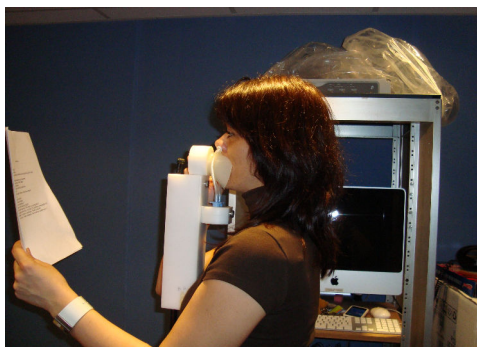
Figure 36 : enregistrement de données aérodynamiques (Brkan, 2009)
