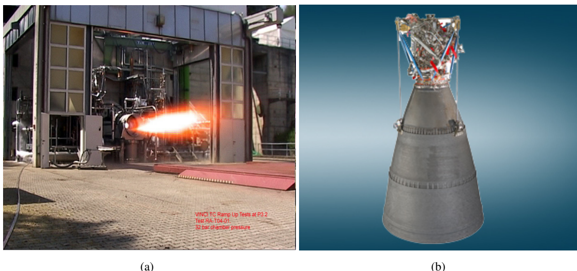
FIGURE 1.7: (a) : Test d'allumage du moteur Vinci dans une installation du DLR [8]. (b) : Le moteur Vinci [Crédit : ESA].
