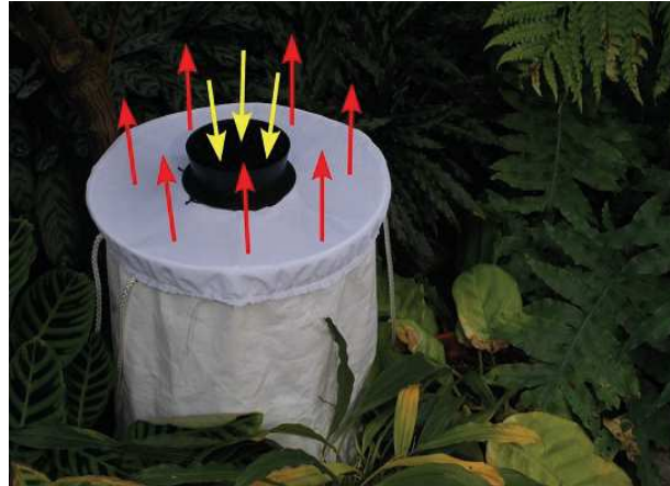
Figure 10 : Piège Bg-Sentinel. Les flèches jaunes indiquent la zone d'aspiration des moustiques; Les flèches rouges indiquent la zone d'extraction de l'air qui permet de libérer l'attractif chimique placé à l'intérieur du piège (BG-Lure). Adapté de http://www.bg-sentinel.com/ , accédé le 17.03.2013.
