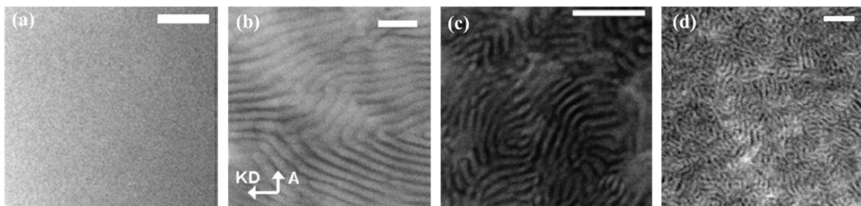
**Figure 3.2.** TEM images of (a) as-PES35,<sup>66</sup> (b) as-PES/PES 10/10 DFBP,<sup>68</sup> (c) as-PES/6FPES 15/15,<sup>69</sup> (d) as-PES/6FPEEK 14/14.<sup>70</sup> Scale bar = 100 nm. Reprinted and adapted with permission from (a) ref.<sup>66</sup> Copyright 2009 Elsevier. (b) ref.<sup>68</sup> Copyright 2009 Elsevier. (c) ref.<sup>69</sup> Copyright 2013 Wiley Periodicals, Inc. (d) ref.<sup>70</sup> Copyright 2011 Elsevier.
