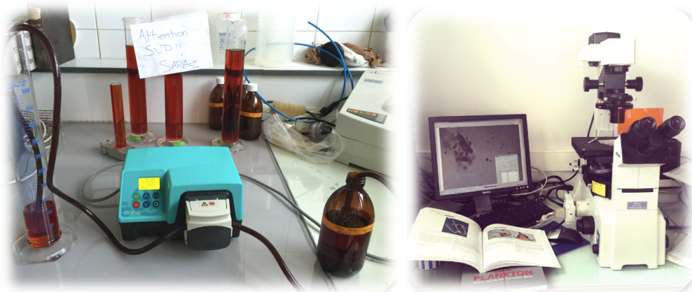
Figure 2: Quelques images prises lors de l'aspiration du surnageant (image gauche) et du comptage microscopique (image droite)
