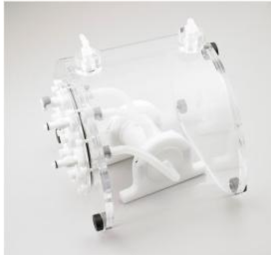
Figure IV-2. Fantôme de perfusion compatible IRM, scanner et PET de l'entreprise Shelley.
