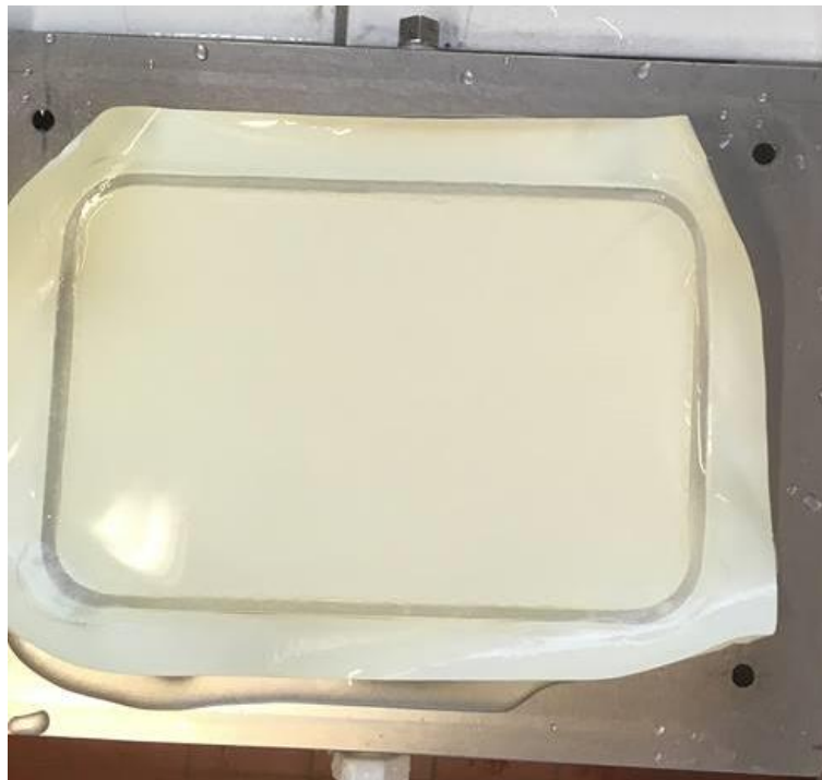
Figure 7 - 9 : Membrane jaunie après filtration de la tropaeoline O (et après les étapes de rinçage et nettoyage)
