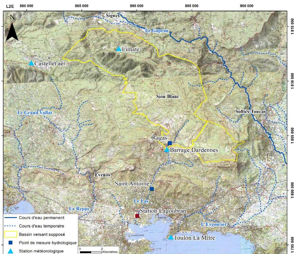
Figure 2-14 Localisation des stations météorologiques et des points de mesures utilisés
