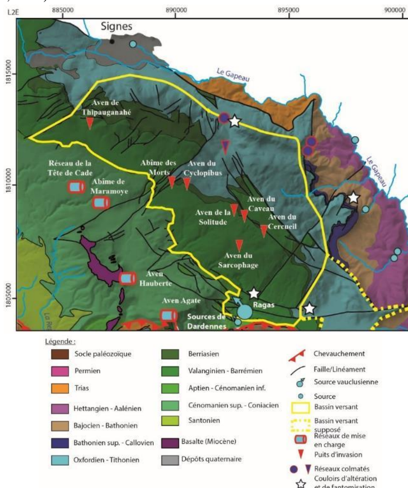
Figure 1-24 Typologie des réseaux karstiques autour des sources de Dardennes (Camus, com.pers.)
