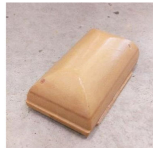
Poinçon parallélépipédique avec congés d'arête
