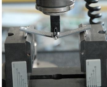
**Figure 3.18** – Essai de flexion 3 points
