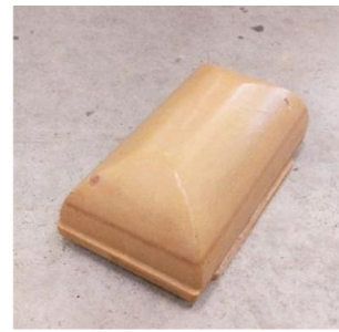
Poinçon parallélépipédique avec congés d'arête
