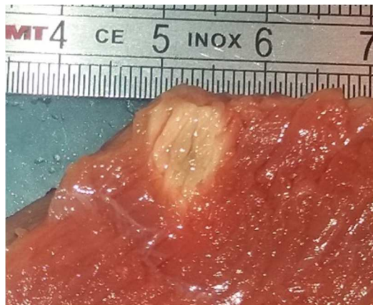
Figure 20. Essai HIFU sur muscle strié (bœuf), placé dans de la gélatine.
