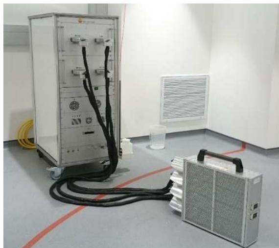
Figure 16. Générateur et adaptateur d'impédance.
