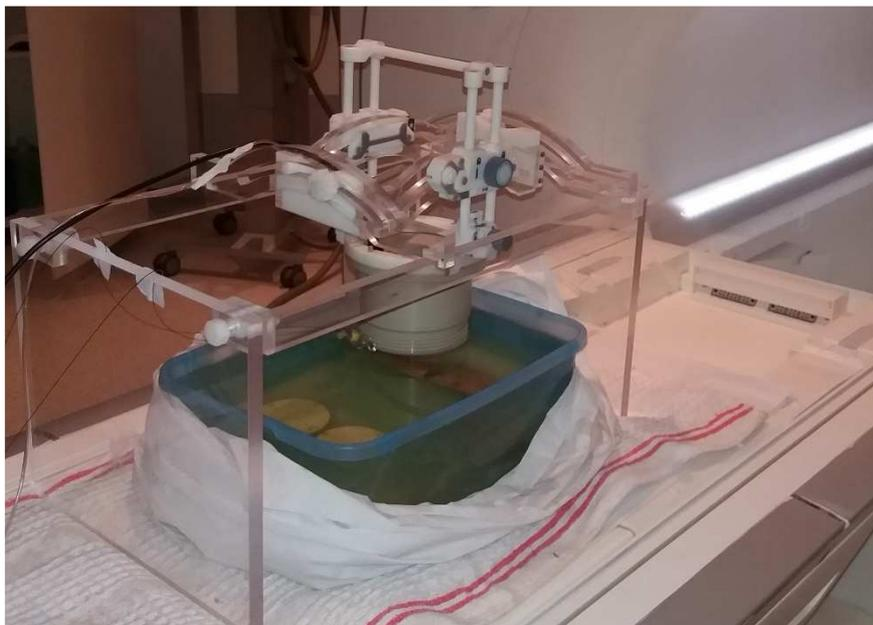
Figure 22. Montage expérimental : fixation du transducteur ( $f=2.7\text{MHz}$ ) au cadre par l'intermédiaire d'un système articulé réglable en profondeur et en angulation.
