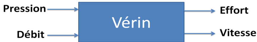
Figure 2 : Mode de fonctionnement d'un vérin pneumatique
