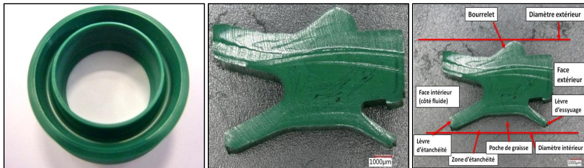
Figure 67: Forme géométrique et profil du joint de tige-racler R25
