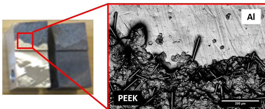
Figure V.42 : Observation MEB de la zone transition entre la fracture qui s'est propagée à l'interface puis dans le PEEK chargé lors de l'essai de traction compacte de l'assemblage pour lequel le greffage a été effectué dans une solution à \text{pH} = 4 .
