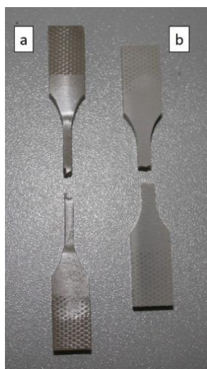
Figure IV.33 : Photographie des éprouvettes de traction pour (a) un PEEK issu d'une plaque injectée et (b) un PEEK fritté par SPS à 300 °C.
