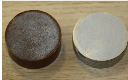
Figure V.3 : Photographie illustrant la délamination, après démoulage de la matrice SPS, du PI (à gauche) et de l'Al attaqué à l'acide chlorhydrique ( 4 \text{ mol}\cdot\text{L}^{-1} ) pendant 10 min à température ambiante (à droite).
