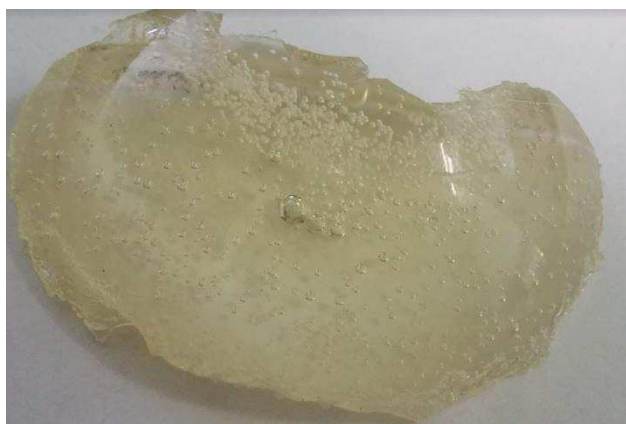
Figure IV-18 : Photographie d'un monolithe PU possédant des hétérogénéités (bulles)
