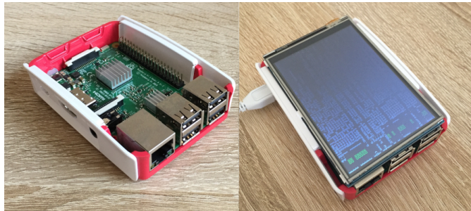
FIGURE 5.12 – Appareil expérimental : Raspberry Pi sans et avec écran tactile.
