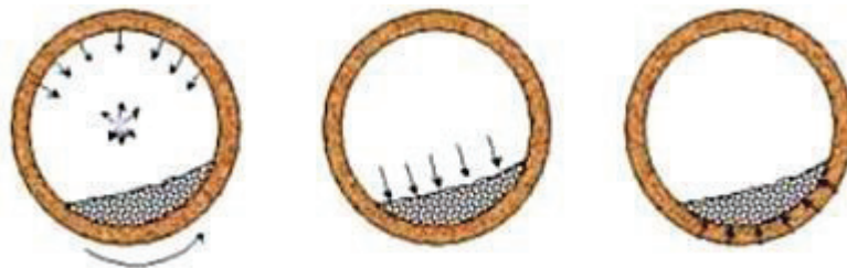
Figure 76 : Transfert de chaleur au sein d'un tambour tournant avec radiation à gauche, convection au milieu et conduction à droite
