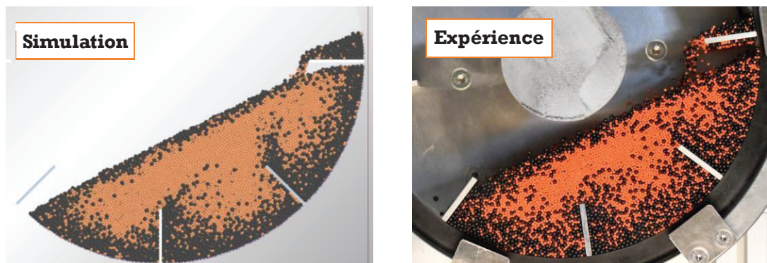
Figure 47 : Image comparative de la face frontale du tambour avec un lit bi-disperse en taille, un taux de remplissage de un quart et 8 ailettes de 4 cm à 2 minutes de rotation. (3 rpm)
