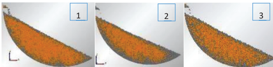
Figure 16 : Répartition spatiale des billes à la paroi avant (vue de devant) pour les 3 conditions de frottement.
