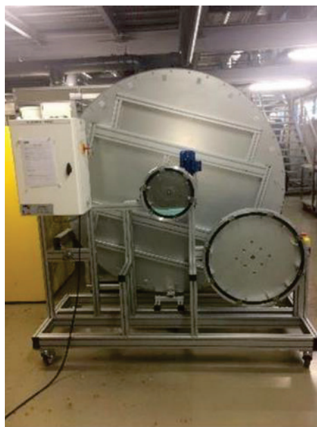
Figure 23 : Vue des tambours de types tranches (2D) de différents diamètres (30 cm à gauche, 60cm à droite et 160cm au second plan)
