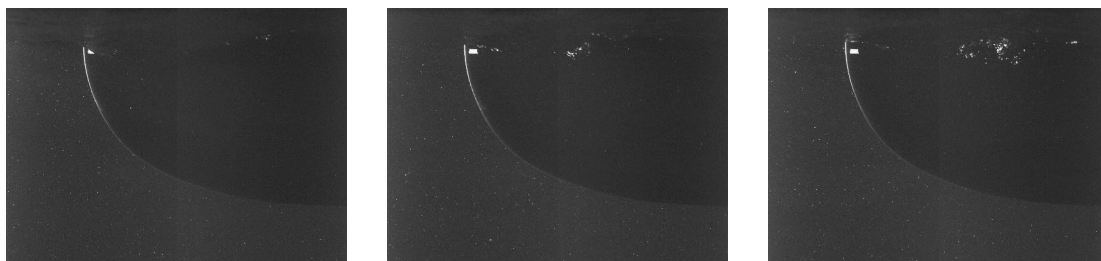
FIGURE 6.3 – Visualisation de l'entraînement d'air de type tourbillonnaire pour l'étrave inversée
