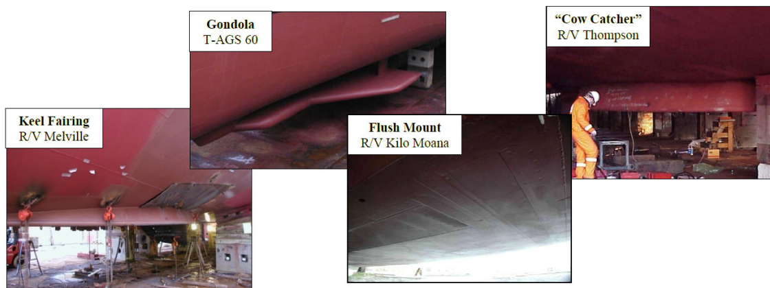
FIGURE 1.5 – Extrait de Rolland et Clark (2010) - Différents types d'implantation des sonars afin de réduire l'influence du phénomène de Bubble Sweep-down
