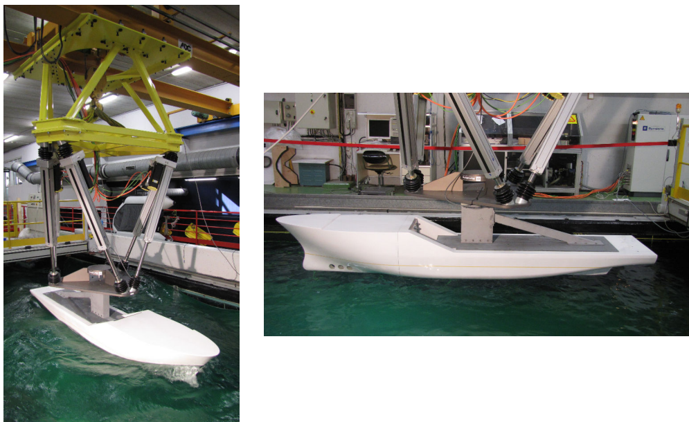
FIGURE 3.3 – [Gauche] Vue du montage du générateur de mouvement (hexapode). [Droite] Vue du montage de la maquette du Pourquoi pas ?
