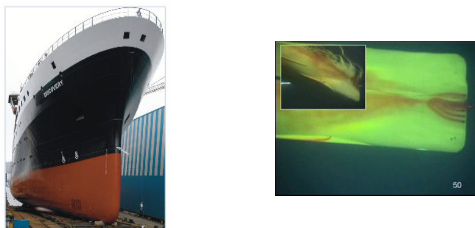
FIGURE 1.7 – Visualisation de la forme d'étrave du Discovery . Illustration des essais réalisés lors sa conception, avec à nouveau la méthode d'injection de colorant.
