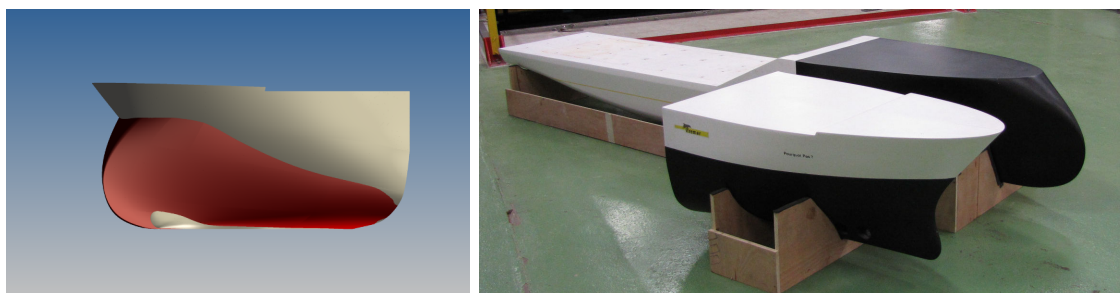
FIGURE 6.2 – Comparaison des formes du Pourquoi pas ? avec les formes du navire équivalent à étrave inversée
