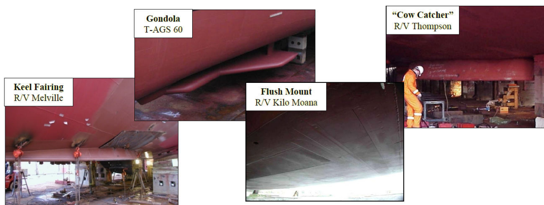
FIGURE 1.5 – Extrait de Rolland et Clark (2010) - Différents types d'implantation des sonars afin de réduire l'influence du phénomène de Bubble Sweep-down
