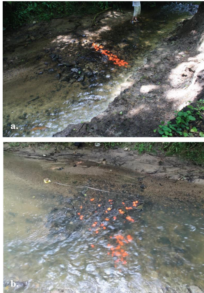
Figure 3.18 : Suivi de la mobilisation de la charge de fond sur un des sites équipés. a. au moment de la réinjection ; b. à l'occasion du relevé de la mobilisation des traceurs.
