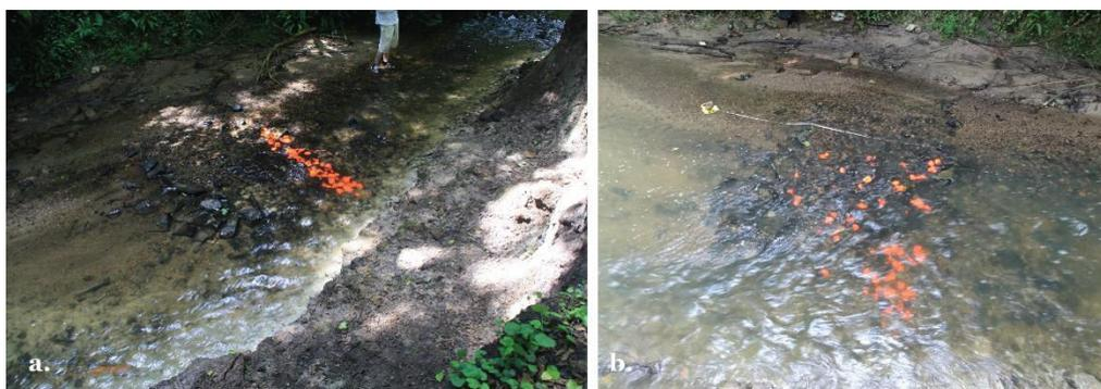
Figure 7.7 : Unique mobilisation de la charge grossière peinte observée au site 4. (a) à la réinjection des éléments peints ; (b.) suivi
