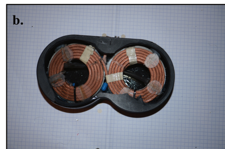
Figure 1.3 : a. Sonde plane avec deux bobines (modèle B-65 Magventure®) b. Intérieur de la même sonde avec l'enroulement des bobines de cuivres et le système de refroidissement.
