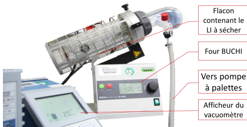
Figure 10 : Montage utilisé pour le séchage des liquides ioniques
