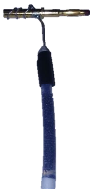
Figure 17 : Compartiment anodique utilisé pour les électrolyses dans les cellules spectro-électrochimiques.
