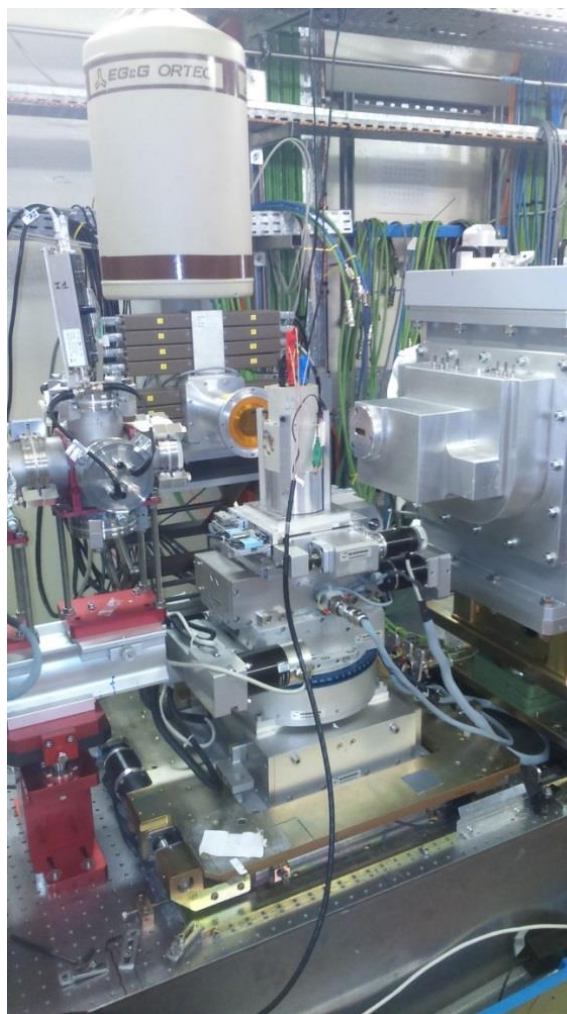
Figure 20 : Plateforme CX3 sur la ligne MARS du Synchrotron SOLEIL.
