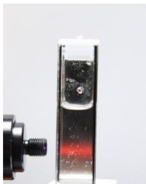
Figure 47 : Fluorescence d'une solution de Eu(NTf 2 ) 3 0,05 M dans [EMIm][NTf 2 ] excitée par une LED à 394 nm
