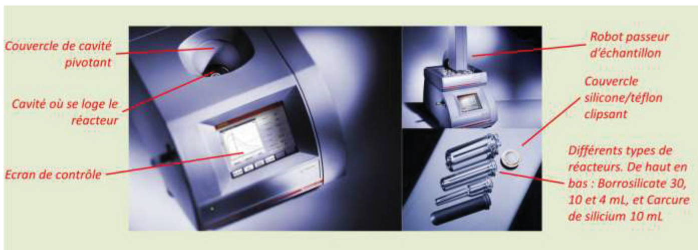
Figure 0-2 : Photos légendée du four Monowave ® qui a été utilisé lors de la thèse. Par souci de clarté, tous les types de réacteurs existants sont présentés, mais seuls les réacteurs Borrosilicate de 30 et 10 mL ont été utilisés durant les travaux présentés ici.
