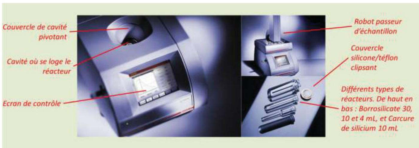
Figure 0-2 : Photos légendée du four Monowave<sup>®</sup> qui a été utilisé lors de la thèse. Par souci de clarté, tous les types de réacteurs existants sont présentés, mais seuls les réacteurs Borrosilicate de 30 et 10 mL ont été utilisés durant les travaux présentés ici.
