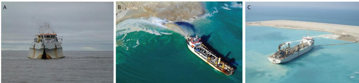
**A) Clapage réalisé par le chaland Le Guerrier (source : <http://www.jandenul.com>) - B) Rainbowing effectué par la drague Alexander Von Humboldt (source : <http://www.theartofdredging.com>) - C) Drague Juan Sebastián de Elcano et déversement sur la plage via des conduites de refoulement (source : <http://www.jandenul.com>)**
