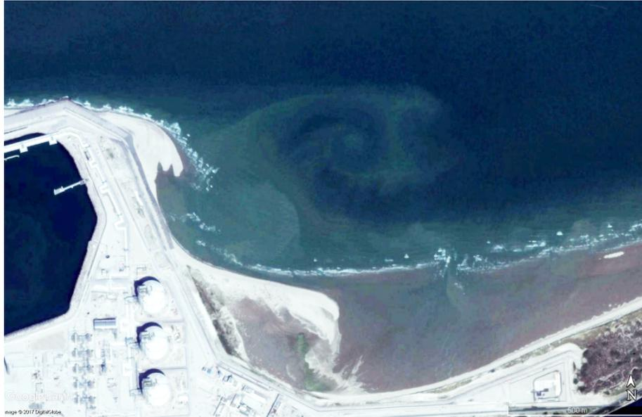
**Figure VII.23** Image satellitaire du 11/09/2015 montrant la présence du contre-courant lors de conditions de vents de secteur est-nord-est à nord-est (Source : *Google Earth*)
