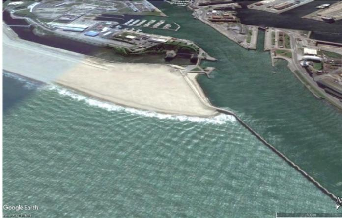
**Figure VI.60** Image satellite, prise le 27/09/2015 montrant l'effet de la jetée Est sur les vagues à haute mer. (Source : Google Earth).
