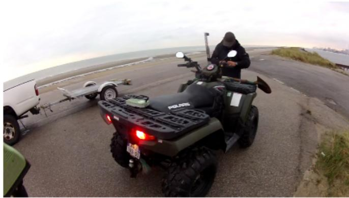
Figure V.3 Système d'installation du DGPS sur un quad
