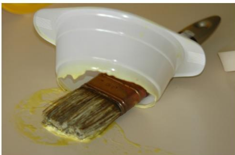
Figure 1. Récipient en polystyrène dégradé par l'Ascabiol®.
