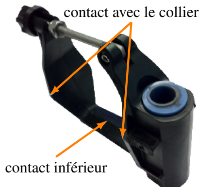
FIGURE 8.4 – Deux liaisons linéaires équivalentes à une rotation instantanée permettant l’immersion de l’aviron
