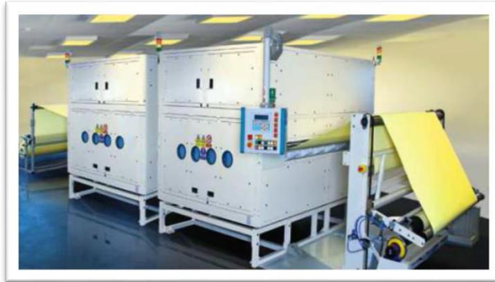
*Figure I. 5. Dispositif de filage Nanospider (Elmarco)*
