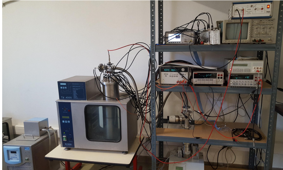
FIGURE 4.26 – Vue d'ensemble du dispositif de mesure directe de l'effet électrocalorique par calorimétrie adiabatique
