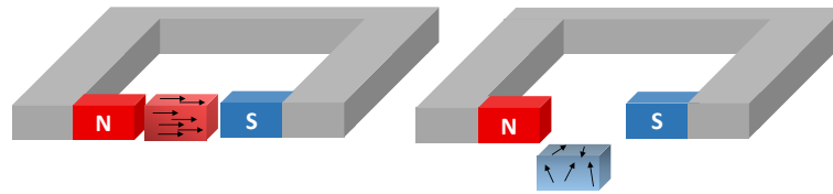
FIGURE 1.8 – Schéma de principe de l'EMC. Le matériau s'échauffe lorsqu'il est placé dans un champ magnétique, il se refroidit lorsqu'il en est retiré.
