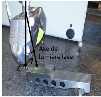
(a) Angle d'inclinaison du capteur dans l'espace de travail
