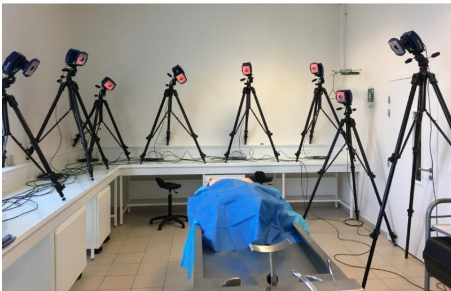
Figure 1. Installation du système de Motion analysis® avec 8 caméras haute définition disposées autour du genou étudié.
