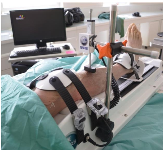
Figure 1. Installation d'un genou cadavérique sur le dispositif de laximétrie GnRB®.
