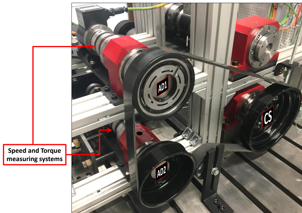
FIGURE 8.14 – Montage expérimental avec le détail du système de mesure de vitesse et de couple.
