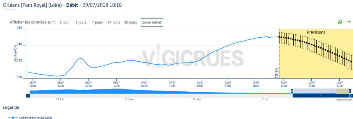
Figure 1.9 – Exemple d'hydrogramme observé et prévu sur Vigicrues pour la Loire au niveau d'Orléans (Source : vigicrues.fr).
