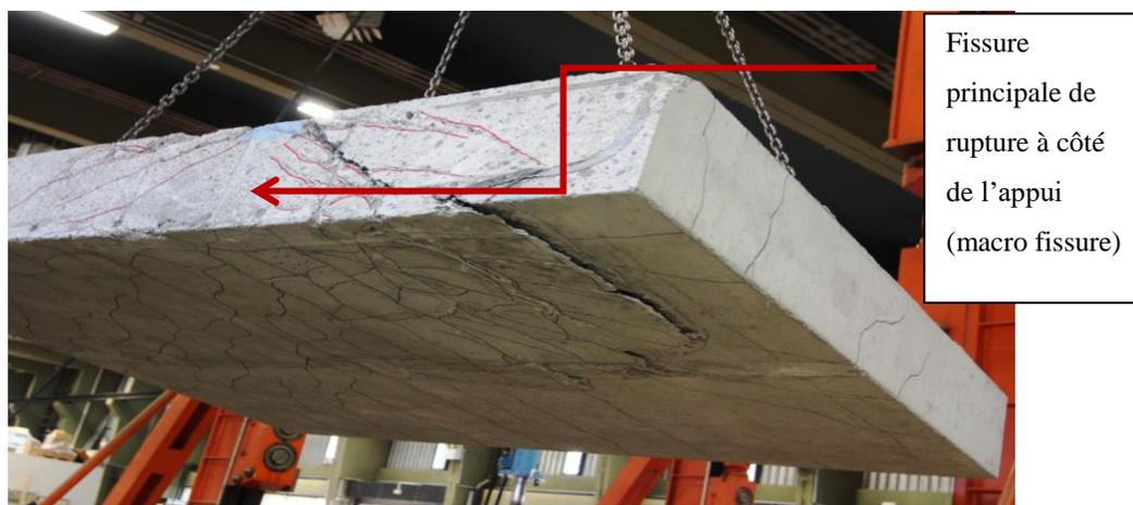
**Figure 4-7** Découpage de la dalle S15 : Mode de rupture en 2D et 3D
