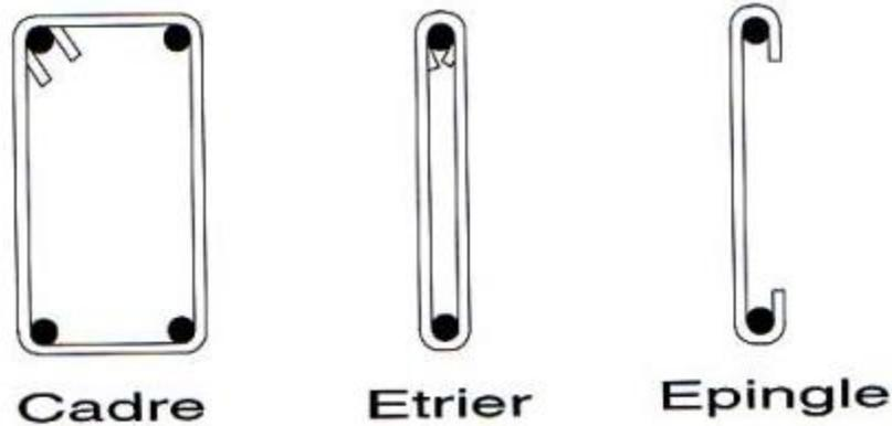
**Figure 2-50** Types d'armatures d'effort tranchant verticales
