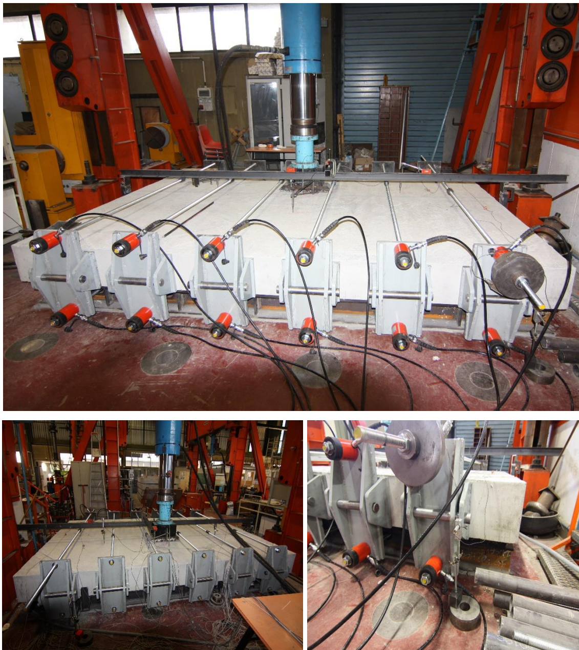
Figure 3-9 Banc d'essai de compression de la dalle SC30
