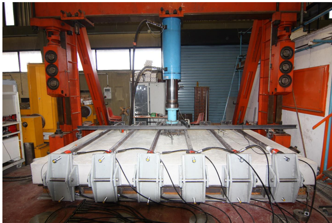
Figure 3-12 Banc d'essai du chargement axial en traction de la dalle ST32
