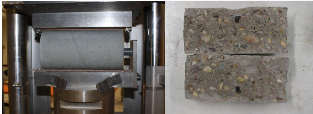
Figure 3-15 Essai de fendage ; a) Presse de fendage ; b) Plan de rupture de l'éprouvette
