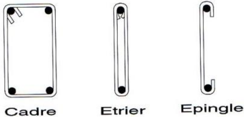
Figure 2-50 Types d'armatures d'effort tranchant verticales
