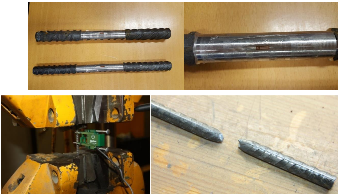
Figure 3-16 Essai de traction directe sur acier : a) Barres HA20 et HA25 usinées et instrumentées ; b) jauge de déformation sur une éprouvette HA25; c) Banc d'essai avec extensomètre ; d) Rupture
