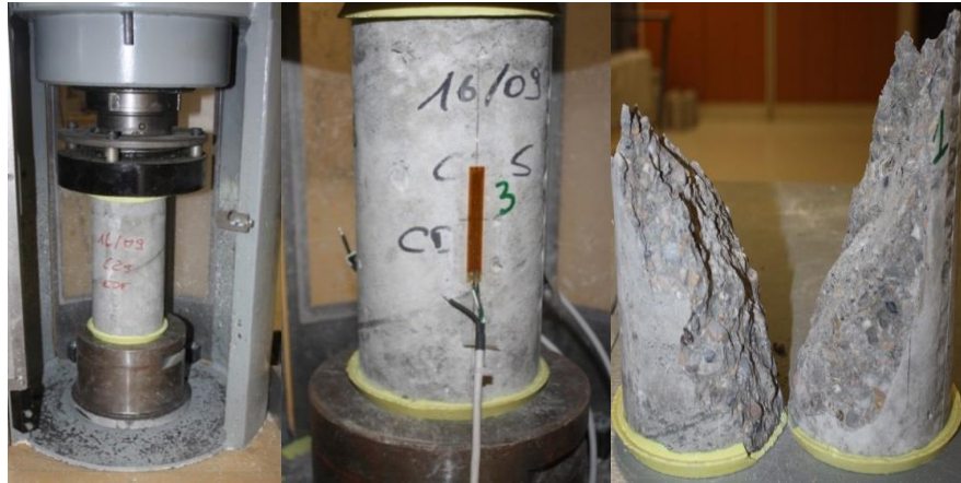
Figure 3-13 Essai de compression uni axiale du béton : a) surfacage d'une éprouvette ; b) Presse de compression ; c) éprouvette instrumentée ; d) rupture
