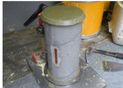
surace plane après surfaçage au soufre
