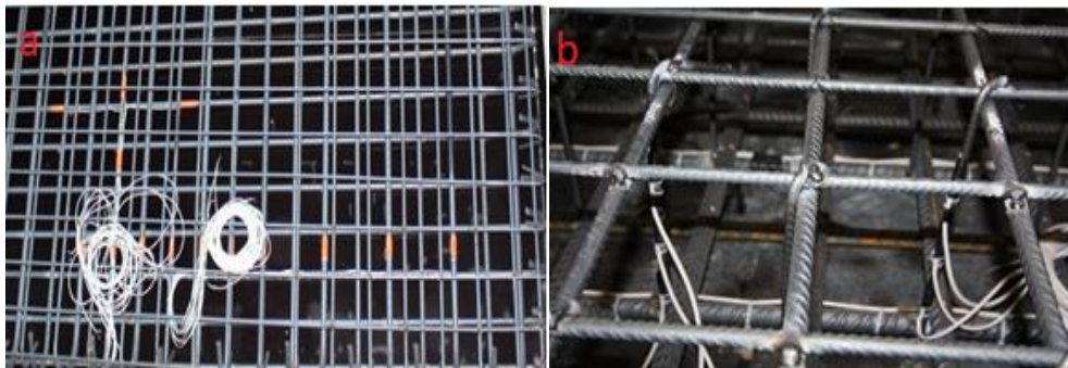
Figure 3-4 a) Jauges de déformations des armatures longitudinales et transversales : dalle S4; b) Jauges de déformation des épingles: dalle S17C
