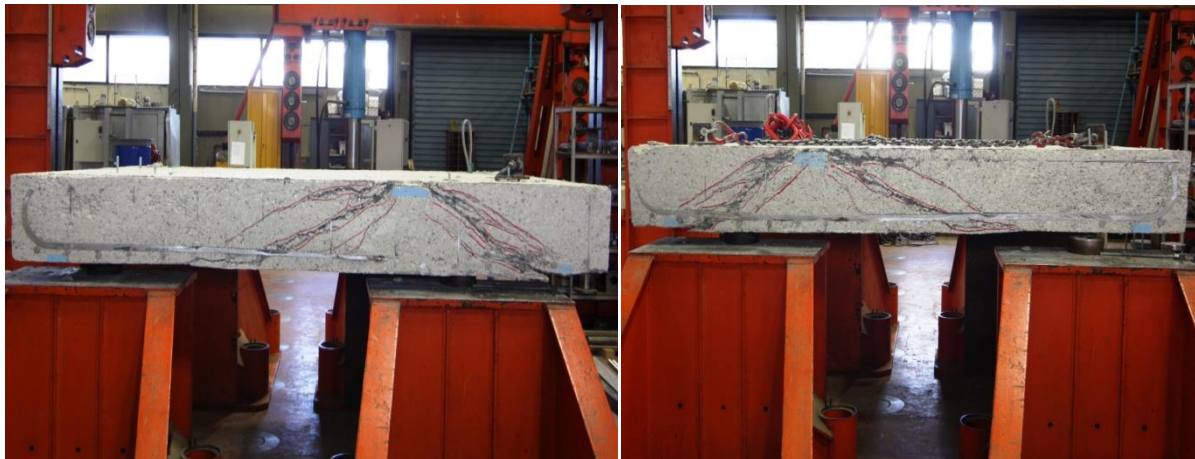
Figure 4-10 Faces 1 et 2 de la dalle S14 sciée
