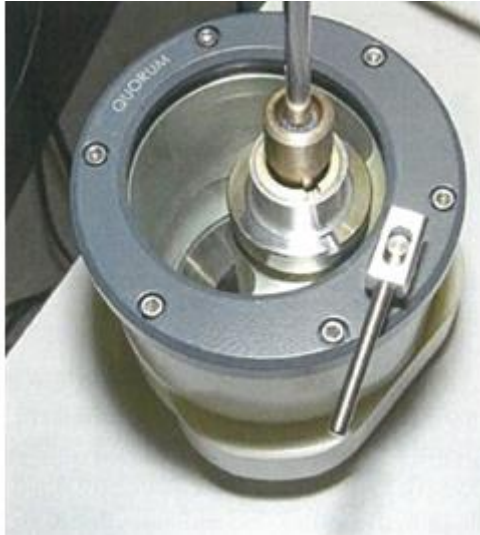
Figure 50 : Photo du récipient de stockage ou "storage pot" permettant de conserver l'échantillon sous vide durant certaines parties de la cryo-préparation ( source : manuel d'utilisation QUORUM®)
