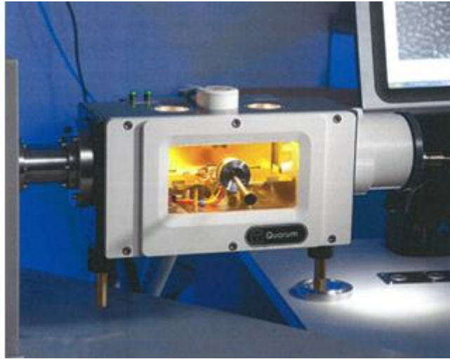
Figure 52 : Photo de la chambre de cryo-préparation (source : manuel d'utilisation QUORUM®)
