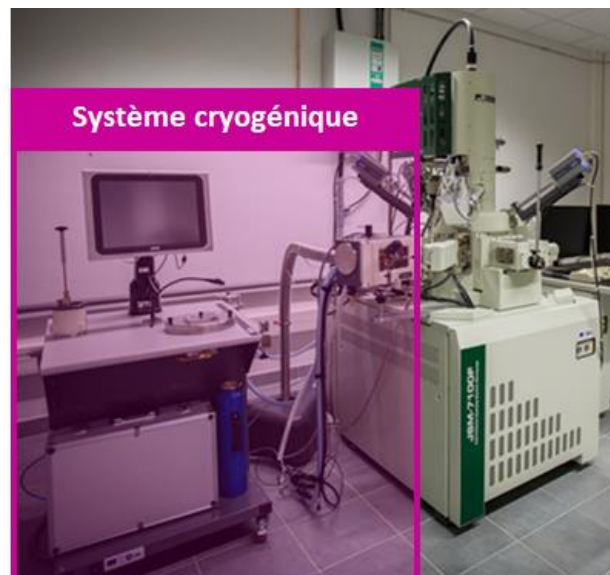
Figure 49 : Photo du microscope électronique à balayage et du système cryogénique associé (crédits : Marc Fourmentin)
