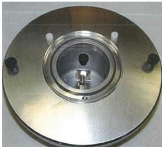
Figure 51 : Photo du récipient à azote pâteux ou "slush pot" ( source : manuel d'utilisation QUORUM®)
