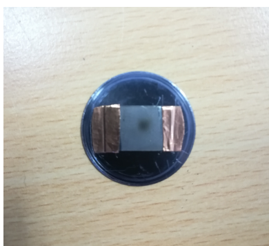
FIGURE 5.5 – Photographie de la cible de béryllium, après irradiation, utilisée sur l'installation AMANDE pour la mesure du spectre neutronique.
