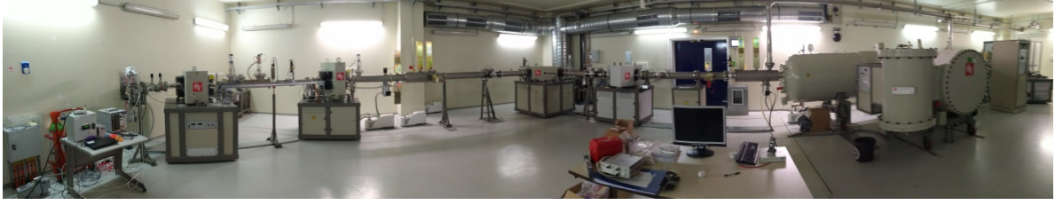
FIGURE 3.10 – Photographie panoramique de l'accélérateur AMANDE avec la chambre de mesure du dépôt d'énergie par ionisation installée en bout d'accélérateur.
