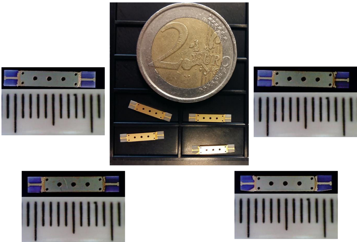
Figure II.65 : Clichés des premiers prototypes en alumine.
