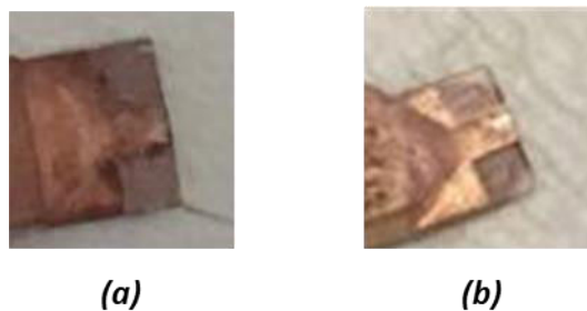
Figure II.88 : Motifs des accès après croissance avec : (a) la 1 ère méthode de masquage (b) la 2 ème méthode de masquage.
