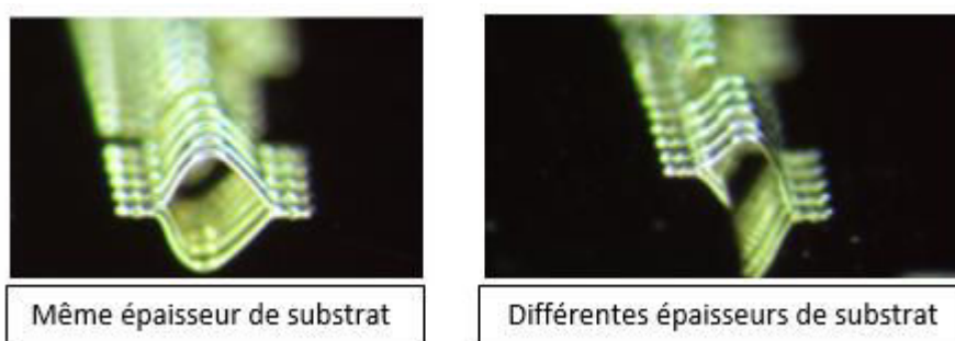
Figure III.94 : Photographies des câblages filaires type "bonding" utilisés à Thales Alenia Space.
