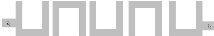
Figure I.18 : Filtre à résonateurs "Hairpin".
