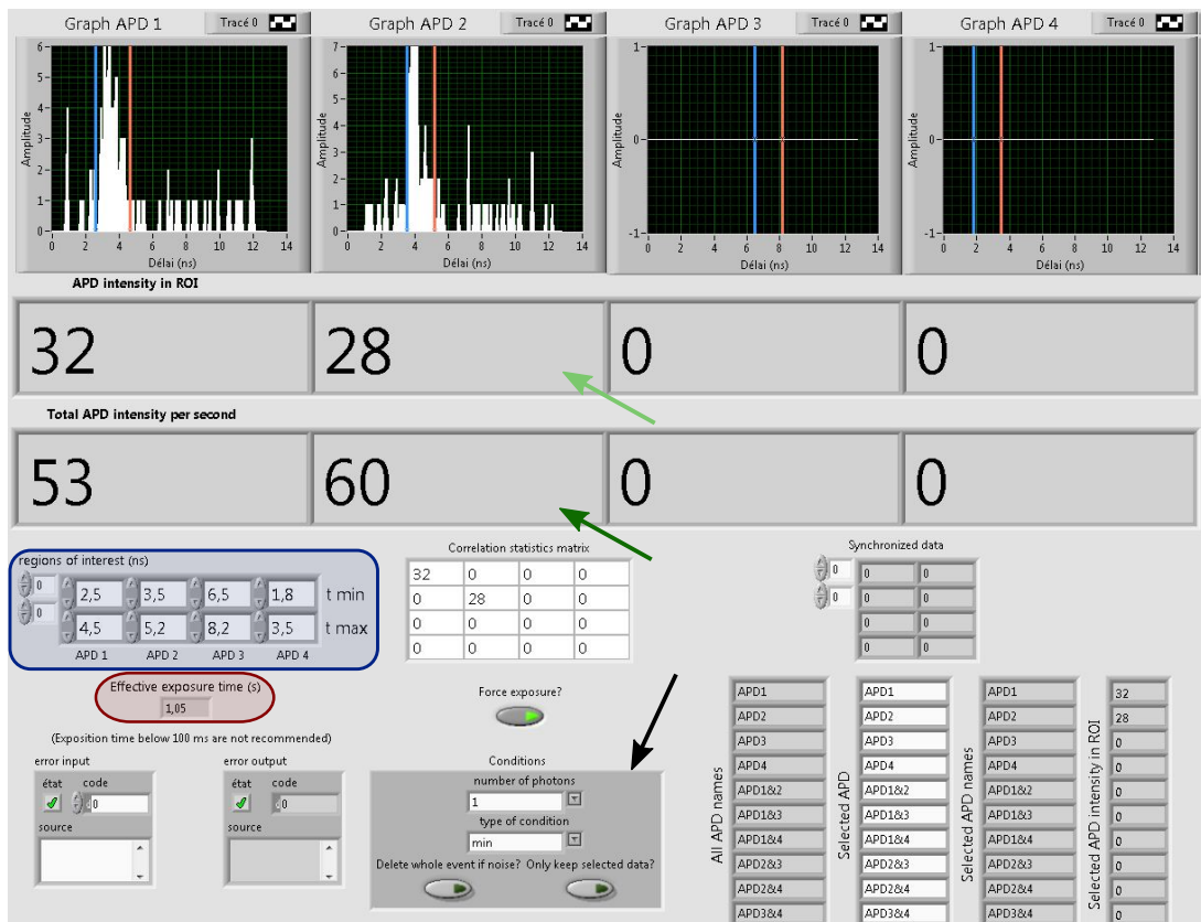
FIGURE 2.12 – Programme de pilotage de la carte d’acquisition, avec les graphes temporels introduits sur la figure 2.11. Le tableau en bleu spécifie les intervalles temporels de mesure, matérialisés par des barres bleues et rouges sur les graphes, tandis que la variable en rouge indique la durée effective d’exposition des détecteurs. Les tableaux indiqués par des flèches vertes indiquent le taux de photons par seconde (dans les intervalles en haut, total en bas), et les variables dans l’encadré gris foncé spécifient des paramètres de sélection supplémentaires.
