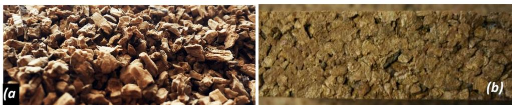
Figure 1.3 – Isolant de liège en vrac (a) et en panneau de liège expansé (b)
