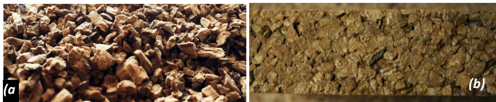
Figure 1.3 – Isolant de liège en vrac (a) et en panneau de liège expansé (b)
