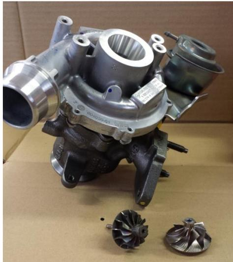
Figure 3-1: Turbocompresseur K9Kgen5 et ses roues compresseur et turbine
