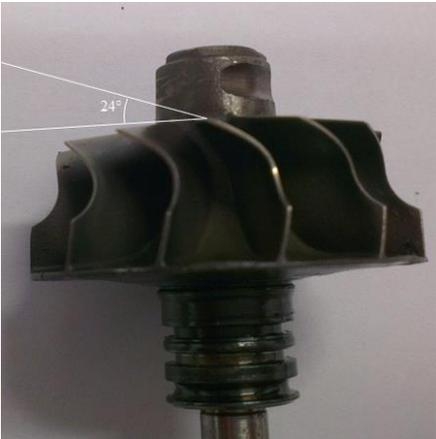
Figure 3-17: La roue de la turbine du turbocompresseur M9Tgen4 HP
