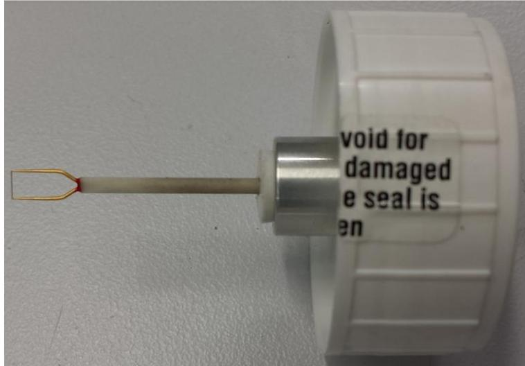
Figure 2-18: Sonde du film chaud Mini CTA, Dantec Dynamics
