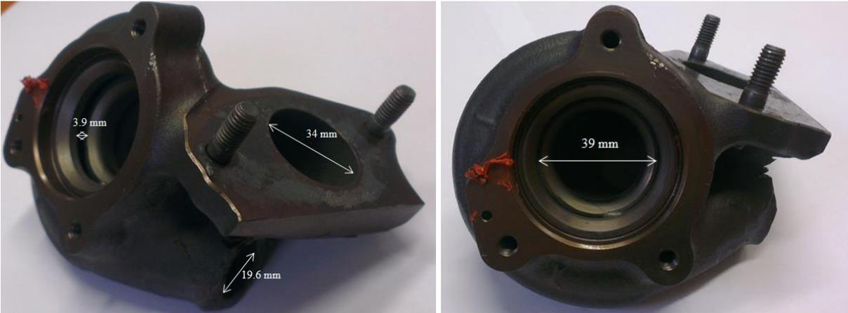
Figure 3-18: Volute de la turbine du turbocompresseur M9Tgen4 HP
