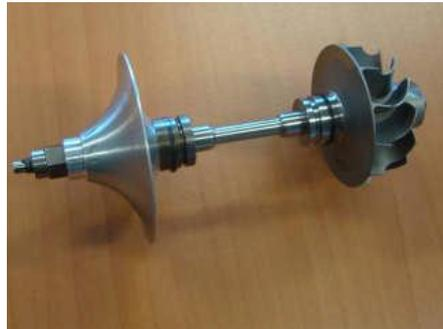
Figure 1-49: Groupe rotor du turbocompresseur (roue turbine, roue compresseur, et arbre) avec un roue compresseur sans aubages (turbo K9Kgen5)
