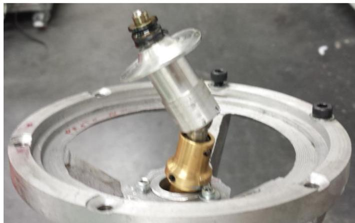
Figure 3-52: Photo du cardan abimé du banc turbine ECN
