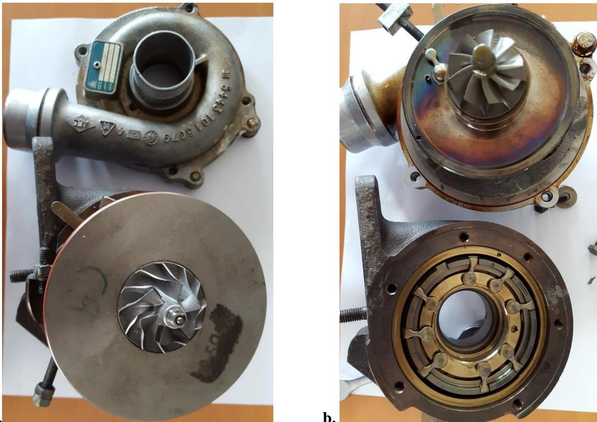
Figure 3-31: photo du turbocompresseur à géométrie variable KP39 VTG 426.18:a. volute et roue du compresseur. b. volute et roue de la turbine
