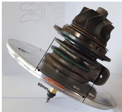
Figure 3-28: Corps central du turbocompresseur M9Tgen4 BP
