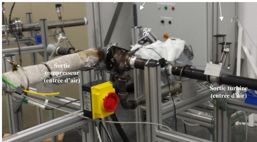
Figure 2-9: Photo du banc d'essai turbocompresseur: la turbine entraînée par le compresseur
