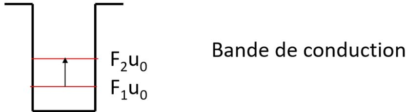
FIGURE 1.11 – Schéma d'énergie de la bande de conduction des puits quantiques de AlGaAs/GaAs/AlGaAs avec deux niveaux d'énergie en rouge, le niveau fondamental défini par la fonction d'onde  $F_1 u_0$  et le premier niveau excité par  $F_2 u_0$ .
