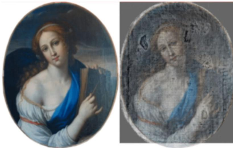
FIGURE 1.5 – A gauche, image dans le visible d’une peinture et à gauche, image par spectroscopie THz qui permet de distinguer les défauts de la peinture dans un but de restauration [7].
