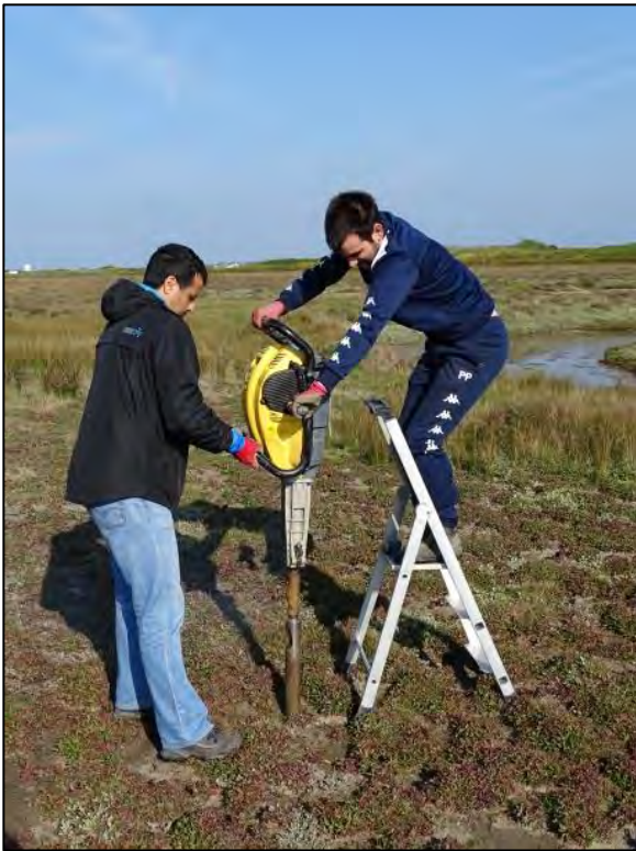
Figure 26 Carottage au vibracore en espace de schorre – mai 2017.
