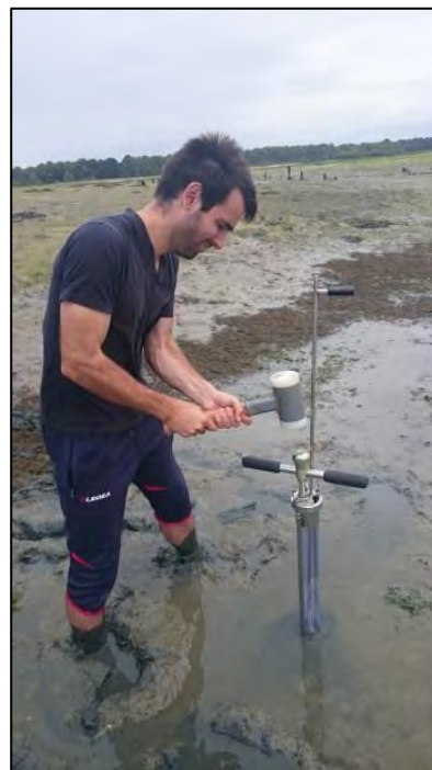
Figure 25 Carottage au Beeker en zone de slikke – août 2016.
