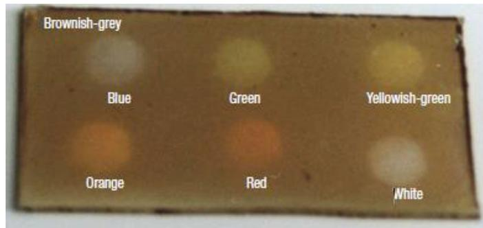
Figure 1-26 : Photo d'un film de  $\text{TiO}_2\text{-Ag}_{\text{NP}}$  éclairé 5 min avec 6 spots monochromatiques (d'après Ohko Y. et al<sup>105</sup>)
