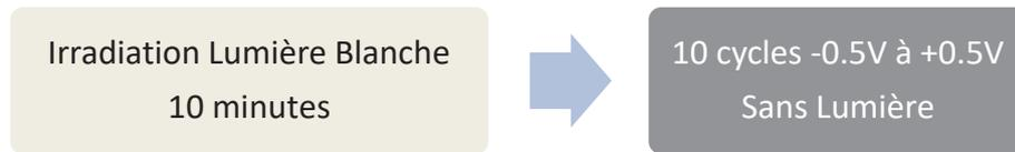
Figure 2-14 : Séquence d'irradiation puis de voltamétrie cyclique
