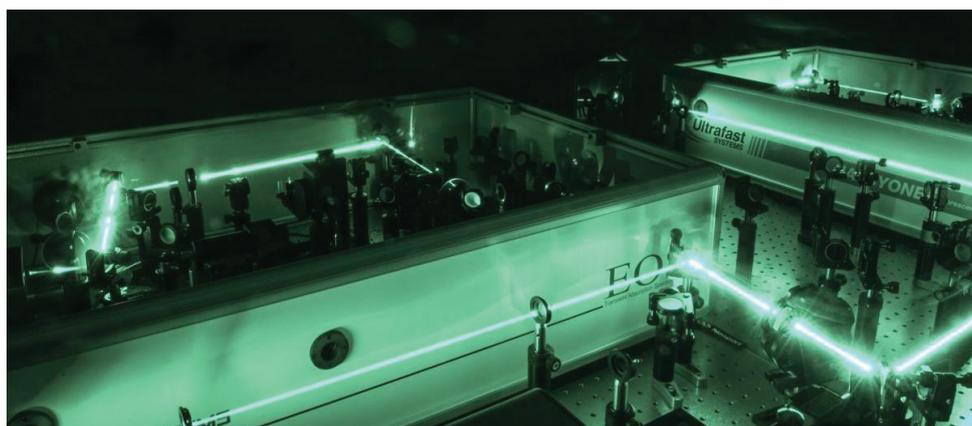
Figure 3-7 : Photo du dispositif expérimental de spectroscopie d'absorption transitoire
