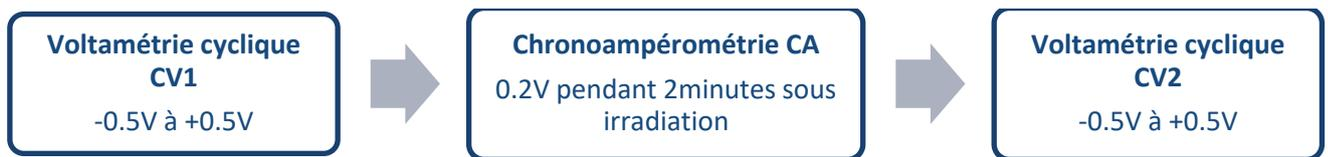
Cette manipulation a montré un effet intéressant : Après une chronoampérométrie (CA) sous irradiation, les pics rédox de l'argent regagnent en intensité (Figure 2-30).
