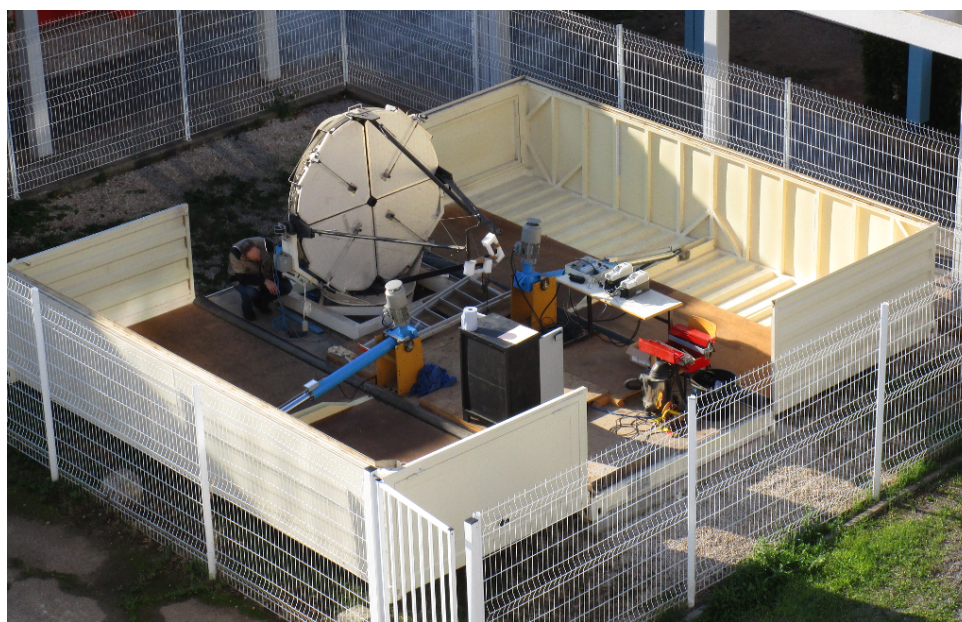
FIGURE 2.28 – Vue d'ensemble du LIDAR dans son conteneur.
