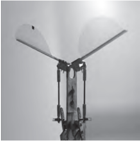
Mouche mécanique , mouvement des ailes de l'insecte mécanique, ©Benjamin Thiria, PMMH, 2011.
