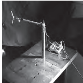
Mouche mécanique , image de l'insecte en action, ©Benjamin Thiria, PMMH, 2011.
